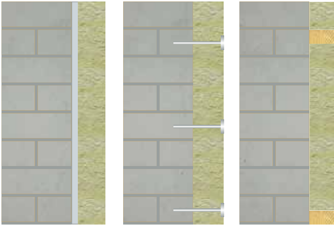
с помощью клея механическим креплением установлена в каркас
